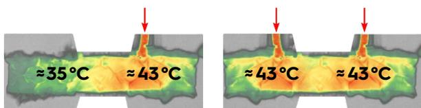
La température de sortie du tuyau est mesurée de manière fiable grâce à des capteurs situés aux sorties des deux tuyaux.
